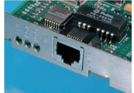
写真6 Ethernet コネクタの外観(10Base-T/100Base-TX)
