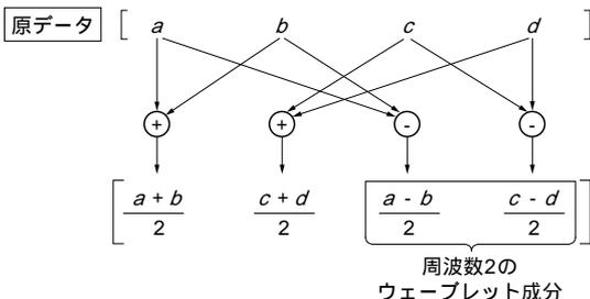
図1 1次元WT(ステップ1, データ数4個の場合)
