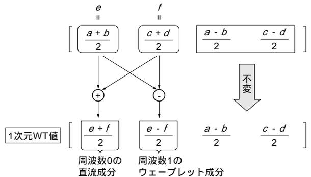
図2 1次元WT(ステップ2, データ数4個の場合)
