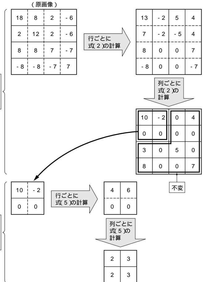
図5 1次元WT値による2次元WT値の算出(4 × 4画素の例)
