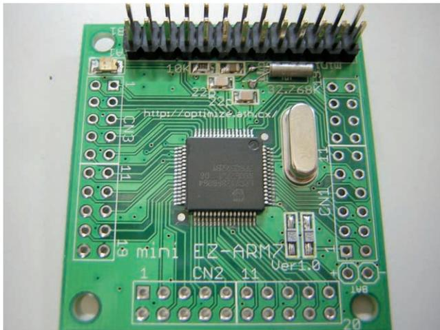
写真1 LPC2138搭載CPUボード mini EZ-ARM7
