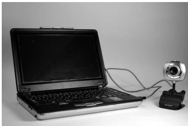
写真1 Intel社製CPU搭載のPCとUSBカメラを用意する ここではUSBカメラを用いたが、ネットワーク・カメラなどでもOK
