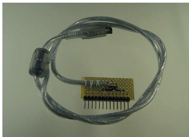
写真1 ゲームボーイ用通信ケーブルを加工した接続ケーブル
