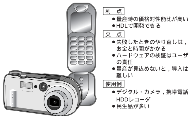
図3 ASIC による信号処理
