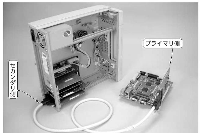
写真6 評価ボードとPCIバックプレーン・システムを接続したようす
