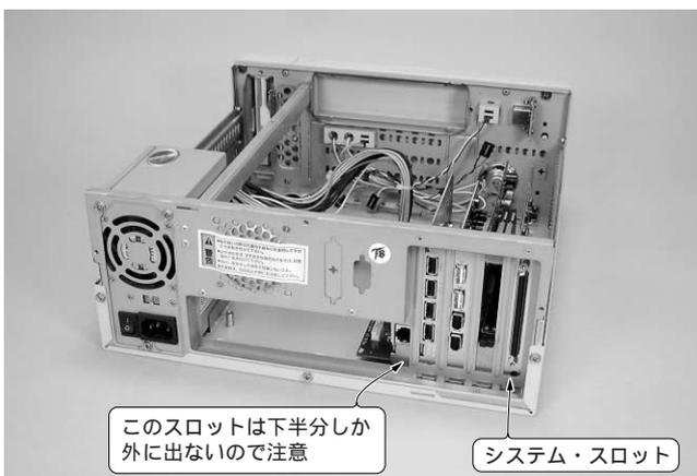
写真5 MicroATX筐体にPCIバックプレーン・ボードとPCI-PCIバス・ブリッジを実装したようす
