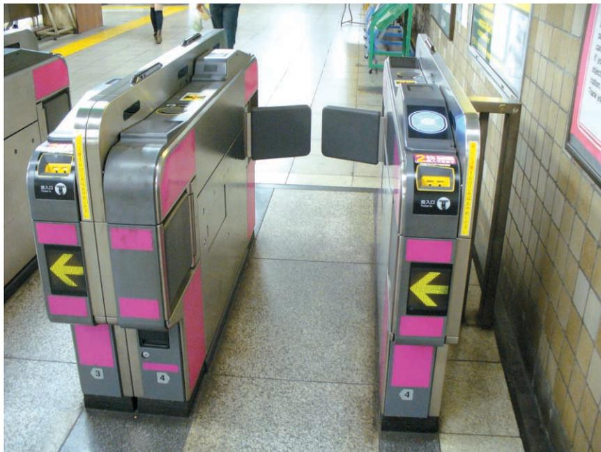
写真4 鉄道の自動改札機の例
