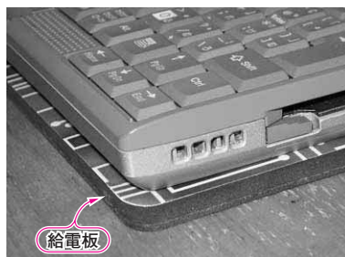
〈写真2〉 非接触給電ならモバイルPCを薄い給電板の上に置くだけで動作させることも可能
