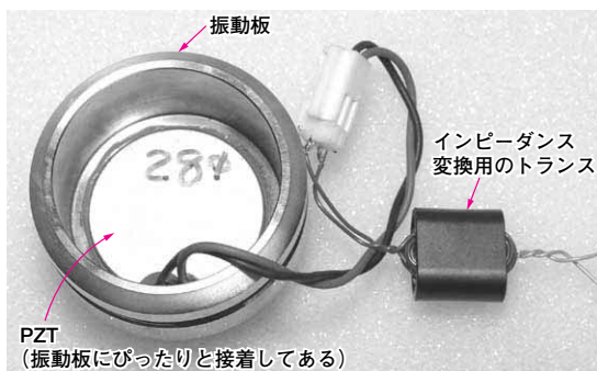
写真8-1 PZTを取り付けた振動板の外観
