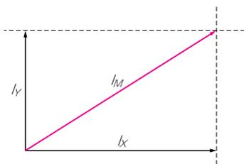
図13-2 2次元ベクトル  $I_x$ ,  $I_y$  とその合成ベクトル  $I_M$  の関係
