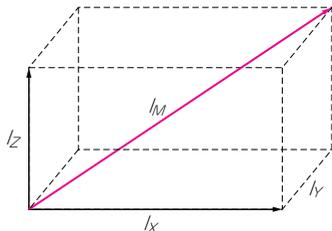
図13-3 3次元ベクトル  $I_x$ ,  $I_y$ ,  $I_z$  とその合成ベクトル  $I_M$  の関係
