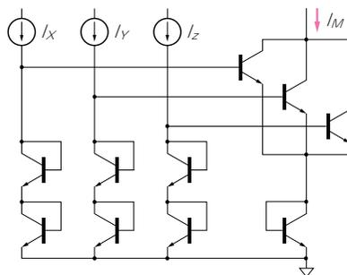
図13-4 3次元ベクトルの大きさを計算する回路
