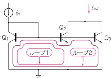
図13-5 1 : 2カレント・ミラー回路を例にして、トランスリニア・ループにトランジスタの並列接続が存在する場合の解析方法を考察する
