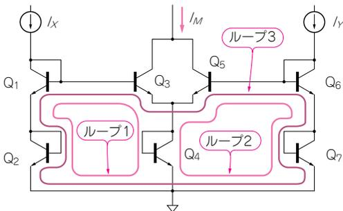
図13-1 ベクトルの大きさを計算する回路
