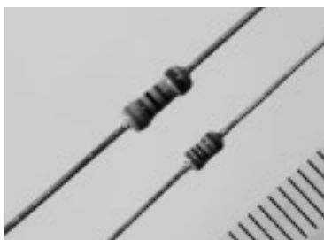
写真1 金属皮膜抵抗器 MFS1/4(KOA)
