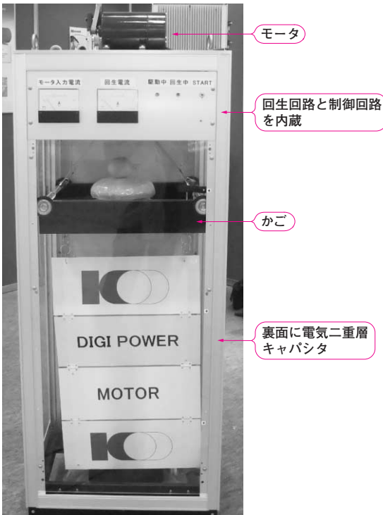
写真1 かご降下時にモータが発電するエネルギーを蓄えて再利用する昇降機(クズミ電子工業)
