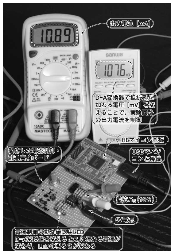
写真1 実験のようす 実際の定電流出力をマルチメータで測定している。定電流の発生源であるR5の電圧低下も併せて計測した。R5は10Ωなので、107.6mVの場合には10.76mAが流れている
