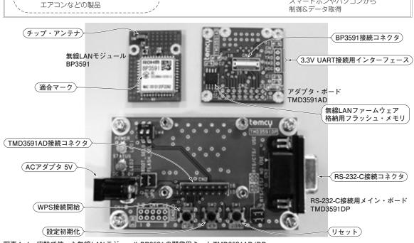
写真4-1 実験で使った無線LANモジュールBP3591の開発用キットTMD3591AD/DP ファームウェア格納用フラッシュ・メモリ、コネクタなどが搭載され、簡単に無線LAN通信を試せる
