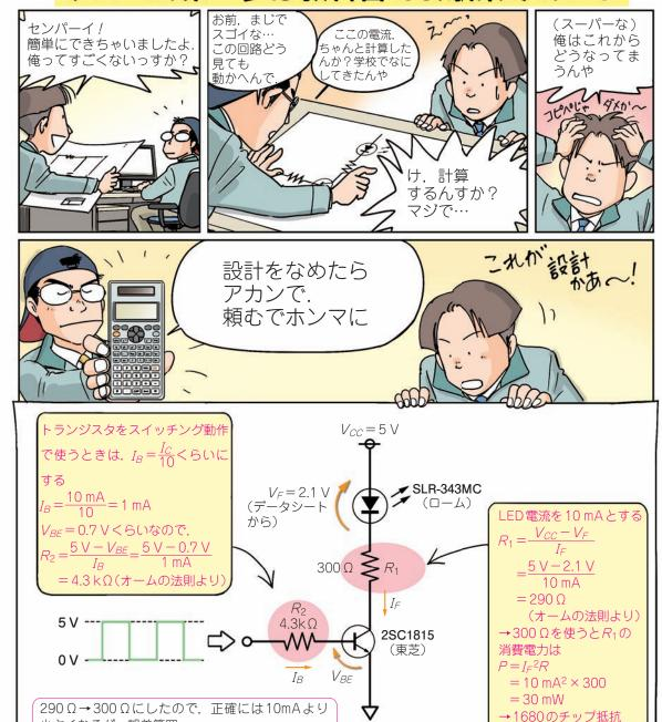
先輩が設計したLED点灯回路
