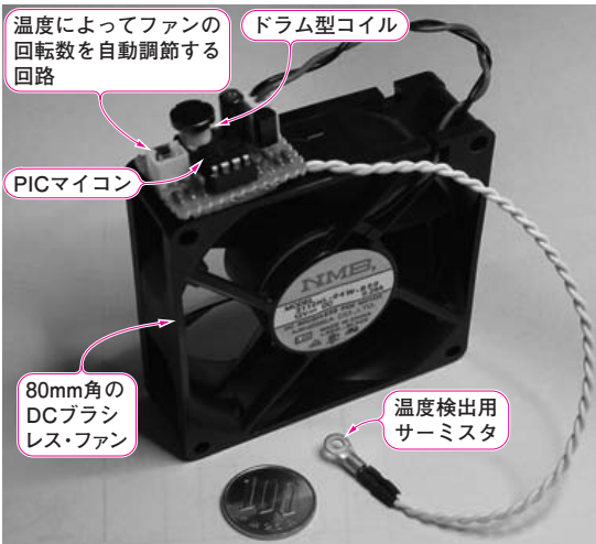
写真1 完成したDCファン・ドライブ用可変電源 温度変化に応じてファンの回転をPICマイコンで制御しつつ、高い変換効率でDCファンを回転させる完成した制御基板は、ヒートシンクは未使用で100円玉2枚程度の大きさ
