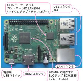
写真1 自作オーディオに革命! ラズベリーパイの登場 ラズベリーパイで192 kHz, 24 ビットのハイレゾ・ネットワーク・オーディオが簡単に作れる
