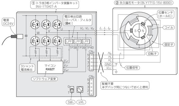
図1 永久磁石モータのセンサレス 120°通電制御の実験構成 位置センサ(ホールIC)を使用せずに、120°通電方式で速度制御系を構成する
