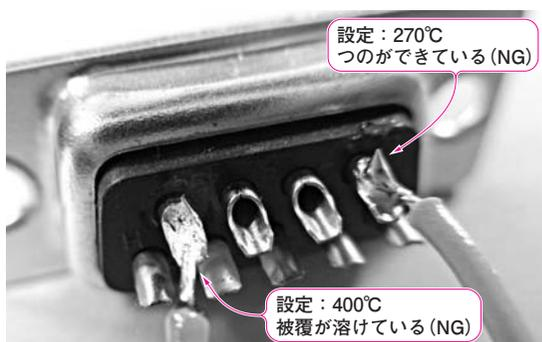
写真1 コネクタへのはんだ付け…こて先温度によって仕上がりが
