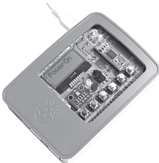
写真1 本誌の付録プリント基板に部品(別売)を載せて組み立てたIoT電子工作ガジェット
