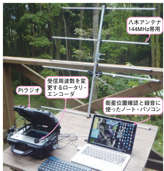
写真1 気象衛星からの電波を受信するシステム 八木アンテナとPiラジオ、ノート・パソコンの組み合わせ
