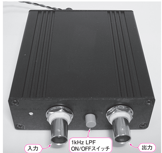
写真2 0.35nV/√Hzの超低雑音アンプ基板をケースに収めたところ(LNA-4)
