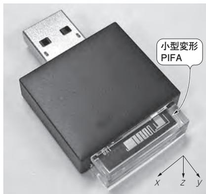
写真1 小型基板アンテナの3Dシミュレーションその① 小型変形PIFA(Planar Inverted-F Antenna)
