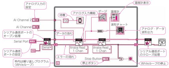
図1 LabVIEWを利用すると,Arduino内のアナログ・データ取り込みや結果表示のプログラムを機能ブロックを組み合わせるだ けで作れる
