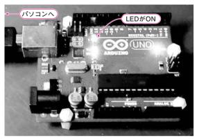
写真1 パソコン上のLabVIEWから Arduino に搭載されたLEDをON/OFFできる
