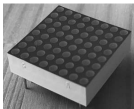
写真1 電子パーツとして売られているドット・マトリクスLED
