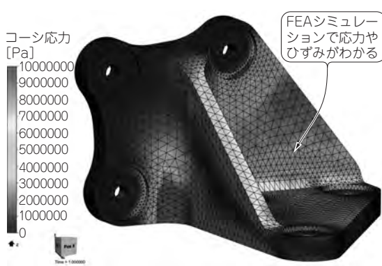
(b) 機械部品の静負荷の有限要素解析(Code_Aster)
