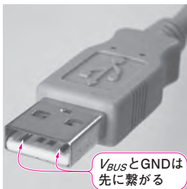
(a) Type-Aプラグ(ケーブルのホスト側)
