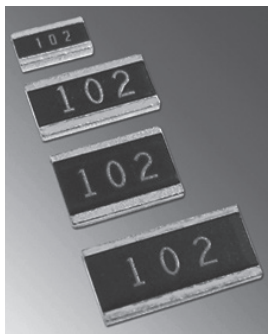
写真1 長辺電極厚膜チップ抵抗器WK73シリーズ(KOA)は、電極のサイズが大きいため基板への放熱性が高いため高電力回路に向く
