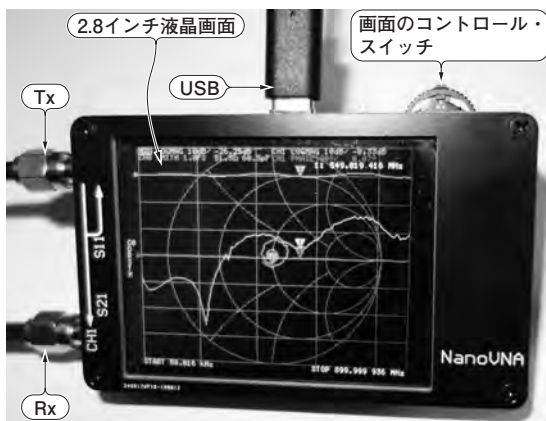
写真1 NanoVNAの外観 送信用Txと受信用Rxポートは固定され、 S_{11} と S_{21} を測定して2.8 インチ液晶パネルに表示する
