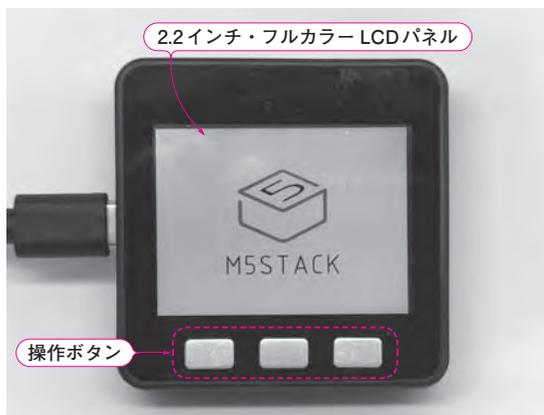
写真1 オールインワンでコンパクトなモジュールM5Stack
