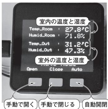
写真1 M5Stackで室内と室外の温度と湿度を並べて表示する
