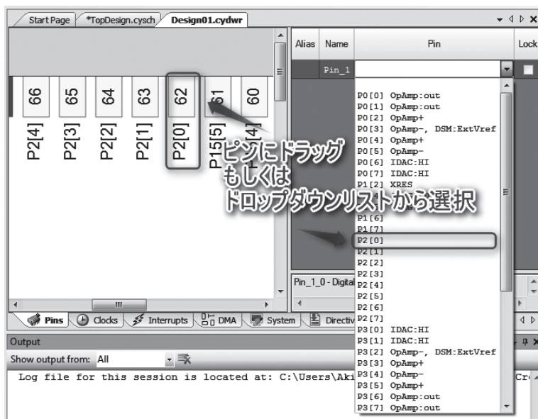
図 11 ピンのアサイン。ドロップダウン・リストから選ぶか、左の各ピンの足にドラッグする
