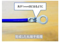
引っぱっても抜けないことを確認します。 もし抜けるようだったら半田を流して固定します。 ※工具によっては抜けやすい場合があります。
