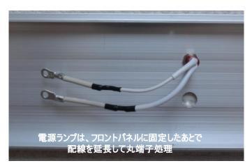
電源ランプの配線は短いため半田付けして延長します。 半田部がショートしないように収縮チューブを被せます。
