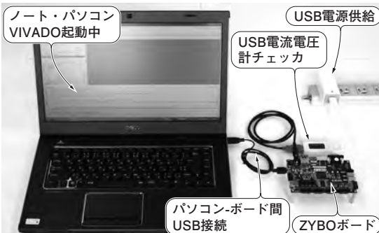
写真1 実験機材 VIVADOを使ってZYBOボードの消費電力をコントロールしている
