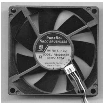
写真7-1 使用するDC ブラシレス・モータ・ファン FBA08A12H(松下電器産業)
