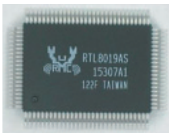
写真1 イーサネット・コントローラRTL8019ASの外観 PCのほか、マイコンにも直結できるイーサネット・コントローラ
