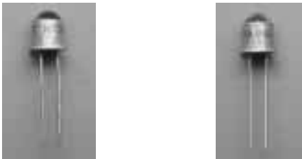
(a) 赤外線LED(TLN108) (b) フォト・トランジスタ (TPS601A)
