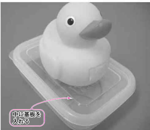
(a) 基板はプラスチック・ケースに入れて防水する
