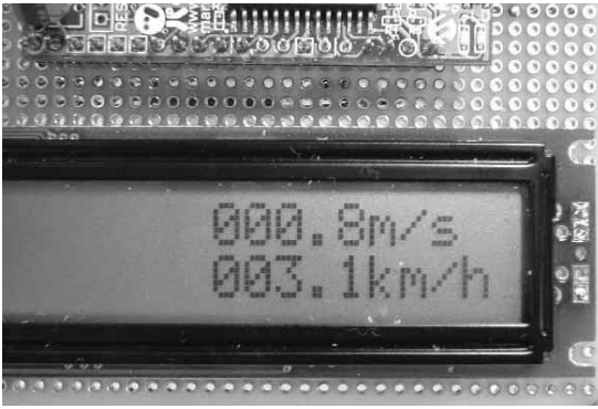
写真2 オフセットをキャンセルしてから1分間静止時の表示 動かしていないのに0.8 m/sと表示されてしまう
