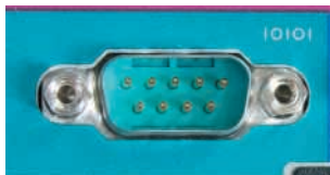
写真1 パソコンに備わっているシリアル・インターフェースRS-232Cの端子
