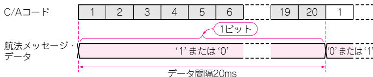
図3 航法メッセージ・データの変調方式
