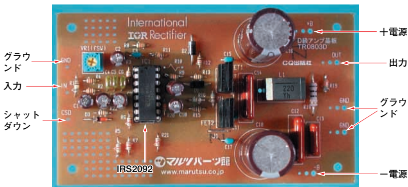
写真1 製作したD級アンプの外観
