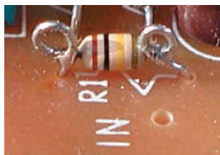
写真2 抵抗を使ったプローブ端子
