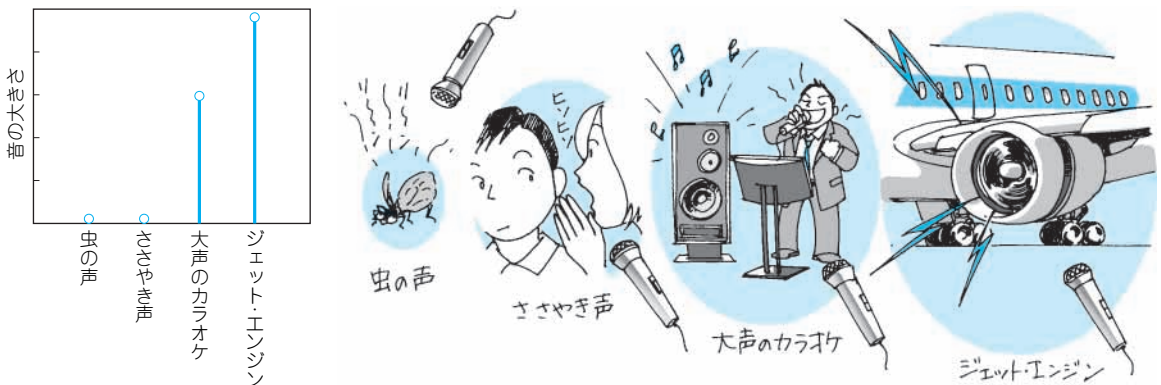
図10-2 普通にグラフをプロットするとわかりにくいもの② 信号のレベル(グラフの縦軸)が非常に広範囲にわたっているもの
