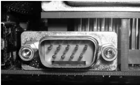
写真5-1 PCのシリアル・ポート用9ピン・コネクタ
