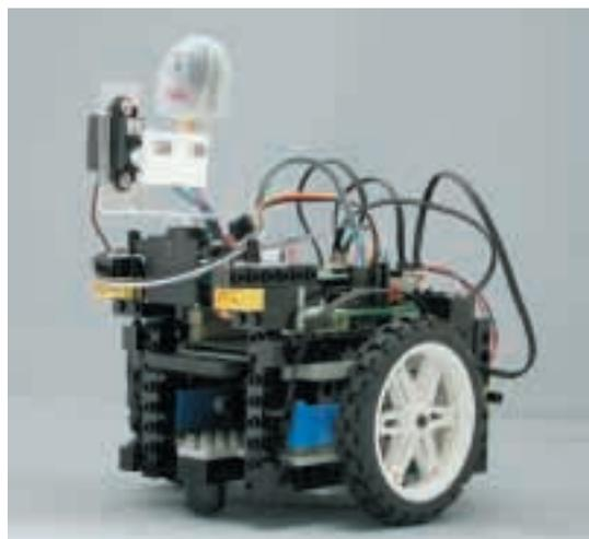
写真B 無線LANカードを搭載した偵察ロボット(第7章)
