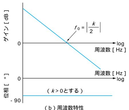
図9-2 CR積分回路と応答時間
