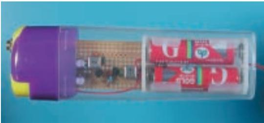
写真9-1 製作したAMワイヤレス・マイクの外観
