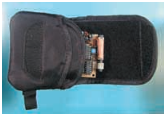
〈写真10-1〉製作した自転車ファインダの外観
