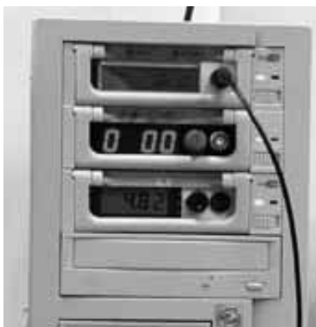
〈写真1〉モバイル・ラックと計測器をパソコンに取り付けたようす(上から順に周波数カウンタ・モジュール, DDSモジュール, 安定化電源モジュール)
